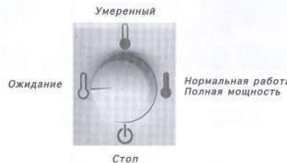
Регулировка температуры в 4 положениях.
