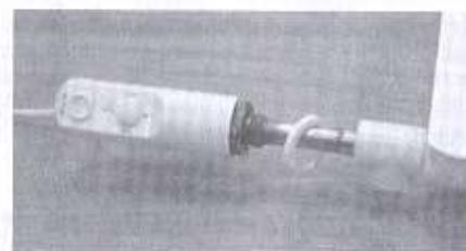
Вставьте спираль и блок регулировки в полотенцесушитель.
