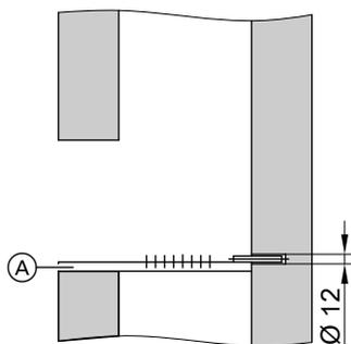
1. По центру задней стенки шахты дымохода просверлить отверстие  $\varnothing 12$  мм для крепления опорной шины (А).
