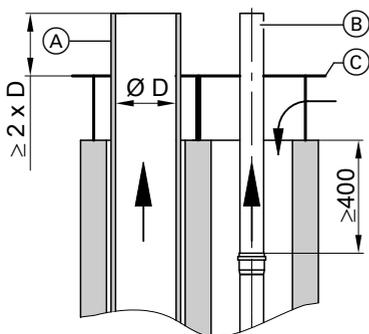
Крышка шахты в качестве общей отражательной плиты (Meidinger Scheibe) должна быть предоставлена заказчиком.
