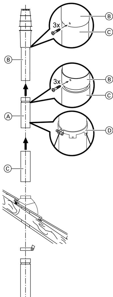
1. Установить внутреннюю трубу надкрышного элемента (А) на проход через кровлю (В) и закрепить тремя прилагаемыми винтами.
