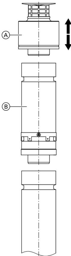
1. Снять верхнюю часть (A) прохода через кровлю.
