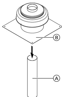
2. Надеть металлический отрезок трубы (A). При необходимости использовать удлинитель (принадлежность).
