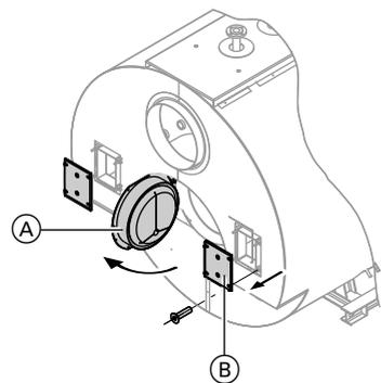
Открутить гайки и снять крышку отверстия для чистки (В). Открыть дверцу отверстия для чистки (А).
