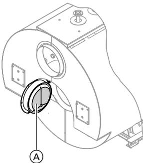
Проверить детали теплоизоляции (A) и уплотнения (B).
