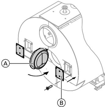
1. Плотно привинтить обе крышки отверстий для чистки (B).
