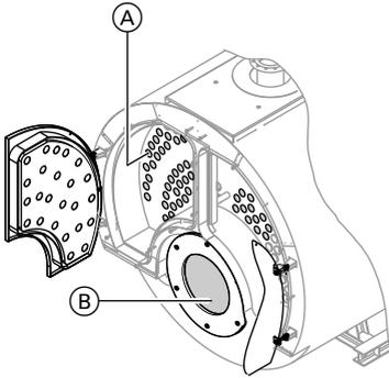
1. С помощью подходящего устройства для чистки очистить газоходы (A), камеру сгорания (B) и заднюю поворотную камеру и удалить остаточные продукты сгорания.
