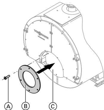
1. Привинтить плиту горелки (B) винтами (A) к фланцу горелки (C).
