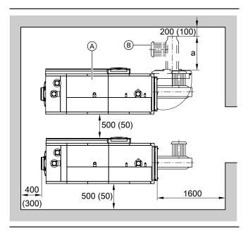
Размер а: Конструктивная длина горелки
