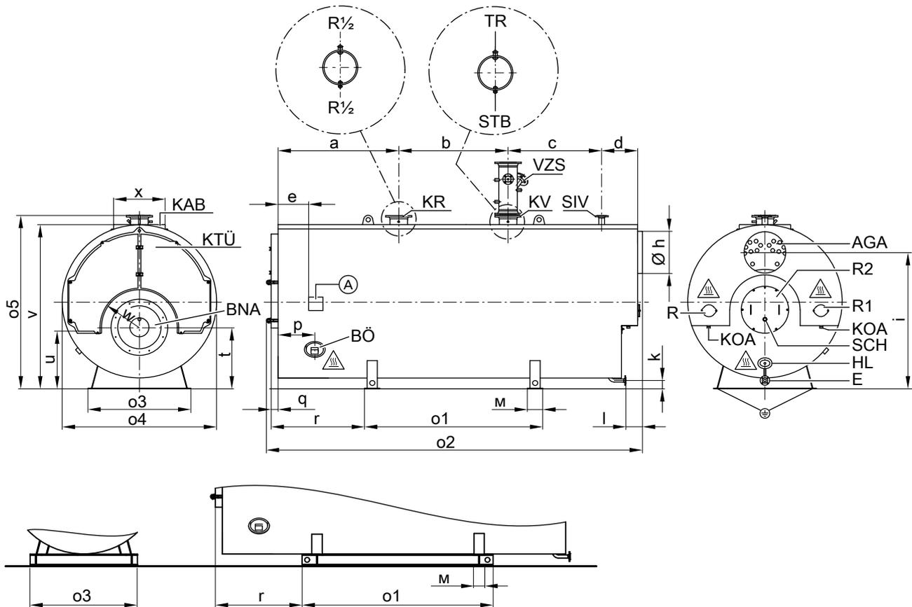
Альтернативная опорная конструкция котла с продольными балками IPB (по желанию за дополнительную плату)
