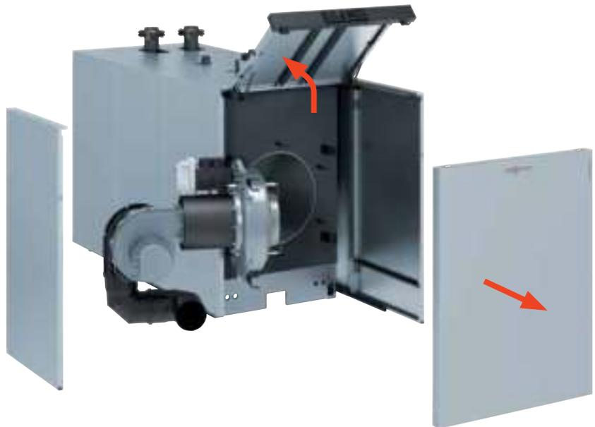
Hohe Service- und Wartungsfreundlichkeit durch aushängbare Seitenverkleidung und klappbare Kesselabdeckung.
