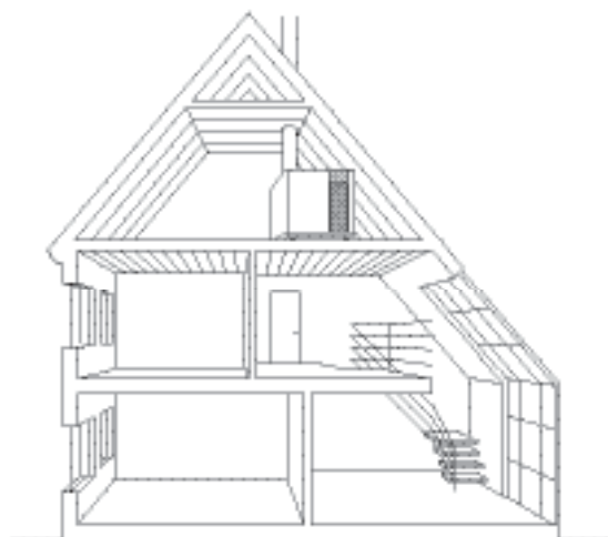
Рис. 15 Установка котла в чердачном помещении
